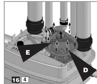
Dévisser les vis **D** de la trappe. Utiliser la poignée **E** pour soulever le moteur avec précaution.
