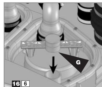
Вновь установить люк. Вновь подключить отвод. С помощью пробки **G** перекрыть выход проводов мотора из люка. Закрепить с помощью хомута **B**.
