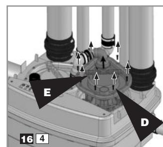
Desapertar os parafusos **D** da tampa. Utilizar a pega **E** para levantar o motor com precaução.
