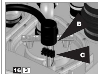
Odkręć pierścień **B**. Odłącz przewody silnika od kostki **C**.
