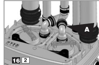
将护罩拆离。旋松故障马达上的套环A(止回阀在进行马达排障时始终位于原位)。
