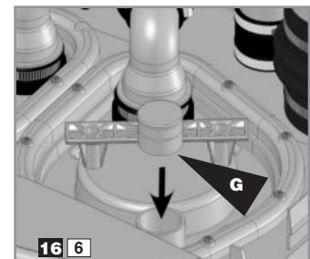
Załącz klapę na miejsce. Podłącz odprowadzenie. Użyj zaślepki **G** do zamknięcia wyjścia przewód silnika z klapą. Przymocuj opaski **B**.
