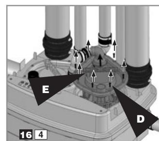
Svitare le viti **D** dello sportello. Usare la maniglia **E** per sollevare il motore con precauzione.
