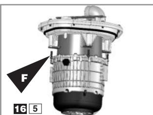
Se o motor defeituoso tiver de ser enviado para reparação ao fabricante, a estação elevatória pode assegurar um serviço mínimo com um único motor. Desapertar os parafusos **F** do motor defeituoso da tampa.
