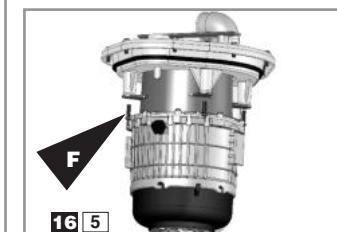
Если неисправный мотор следует отправить производителю, установка может продолжать выполнять минимальные функции с одним мотором. Вывинтить винты **F** неисправного мотора из люка.
