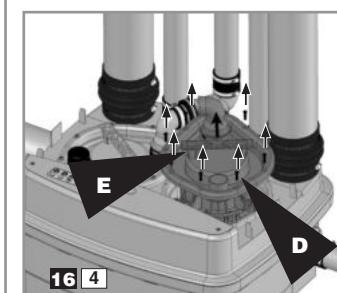
Вывинтить винты **D** люка. Осторожно поднять мотор с помощью рукоятки **E**.
