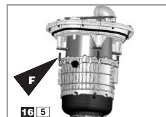
Si le moteur défectueux doit repartir chez le fabricant, vous pouvez laisser le relevage assurer un service minimum avec un seul moteur. Dévisser les vis **F** du moteur défectueux de la trappe.
