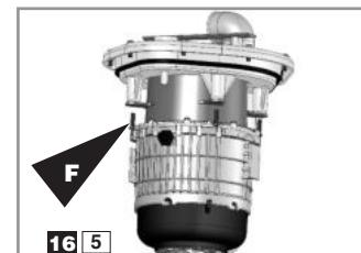
Se il motore difettoso ha un problema tecnico irrisolvibile in breve tempo, potete lasciare che SANICUBIC® Classic assicuri un servizio minimo con un solo motore. Svitare le viti **F** del motore guasto dallo sportello.
