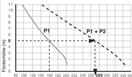
Beispiel: Pumpe P1 arbeitet "normal". Bei 5 m Höhe werden 160 l/min. gefördert. Bei Leistungsaufall von Pumpe P1, oder plötzlich höherem Abwassereinlauf springt P2 ein. Die Förderleistung steigt auf ca. 275 l/min. bis zum Wiedereintritt des Normalbetriebs. Der Zwischenfall wird auf dem Tastenfeld angezeigt, und an den Betriebsmelder [HF-Empfänger] weitergeleitet.
