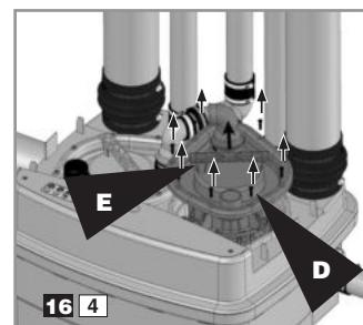
Odšroubujte šrouby **D** víka motoru. Opatrne nadzdvihněte motor za držadlo **E**.
