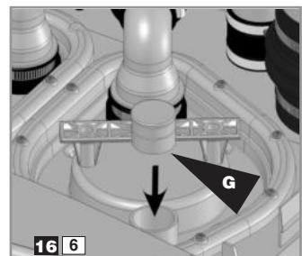
Sätt tillbaka locket. Anslut avloppet igen. Använd propp **G** för att täcka motorledningarnas utgång från luckan. Fäst med slangklämma **B**.
