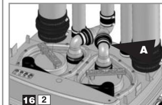
Odkręć pierścień **A** uszkodzonego silnika (podczas naprawy silnika zawór zwrotny pozostaje na swoim miejscu).
