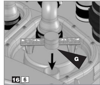
重新装上翻板活门。再次连上排水管。使用塞子G堵上翻板活门马达的出线口。用套环B固定。
