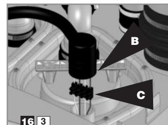
Lossa slangklämma **B**. Koppla bort motoranslutningarna från kopplingsplint **C**.
