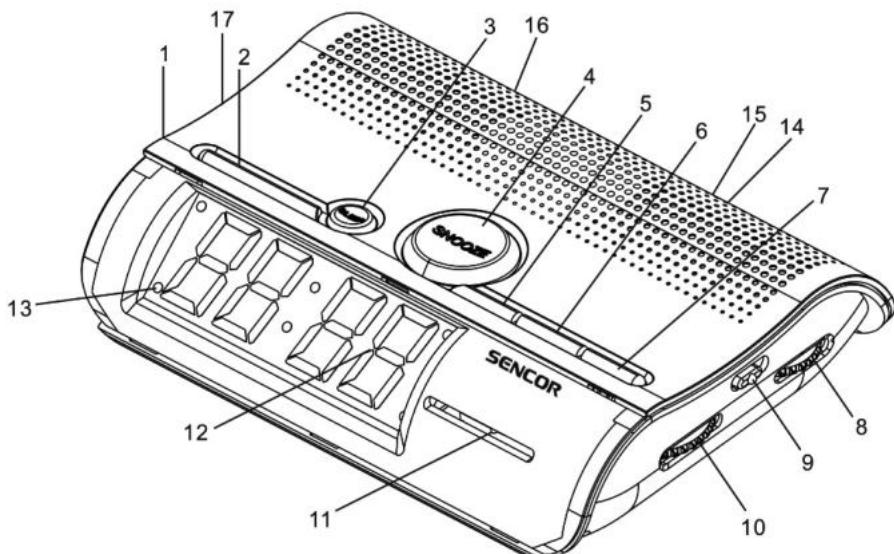
1. Přepínač On/Off/Auto (Zapnutí/Vypnutí/Automatický režim)
