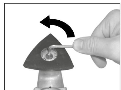
2. A szerszám tartóra tegye fel az új megmunkáló szerszámot, olyan módon, hogy a tartón lévő kiemelkedések a szerszámon lévő lyukakba illeszkedjenek.
