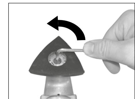
2. Na nosič nástroje nasadte pracovní nástroj tak, aby kolíky na nosiči zapadly do otvorů nástroje.
