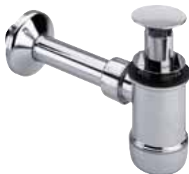
Zápachový uzávěr kompletně pochromovaný, pro umyvadla bez přepadového otvoru. Přepadovou trubku lze vytáhnout o 90 mm
