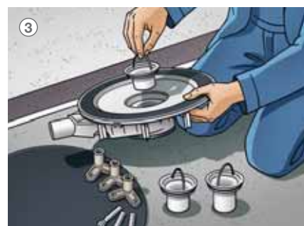
3 Zvolte jednu ze tří ponorných trubek obsažených v dodávce, zde: použití nejkratší varianty.
