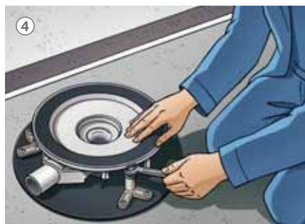
4 Umístěte odtok a zvukově izolační podložku a pomocí výškově nastavitelných montážních podpěr doladte nastavení na milimetr přesně.
