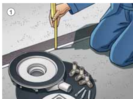
1 Změřte stavební výšku podlahy, zde: 85 mm.
