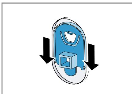
**Poznámka:** Pro nasazení přepravních pojistek do spotřebiče při dopravě provádějte tyto kroky v opačném pořadí.
