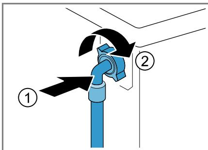
2. Přívodní hadici připojte k přívodu vody (26,4 mm = 3/4").
