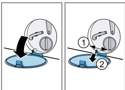
5. Pod otvor postavte vhodnou nádobu pro vypuštění pracího roztoku.
