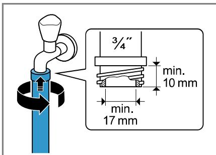
3. Opatrně otevřete přívod vody a zkontrolujte těsnost připojovacích míst.
