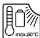
**Захищайте акумуляторну батарею від тепла, зокрема, напр., від сонячних променів, вогню, бруду води та вологи, Існує небезпека вибуху і короткого замикання.**
