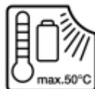
**Zaštitite aku-bateriju od vrućine, npr. također od stalnog sunčevog zračenja, vatre, prljavštine, vode i vlage.**
