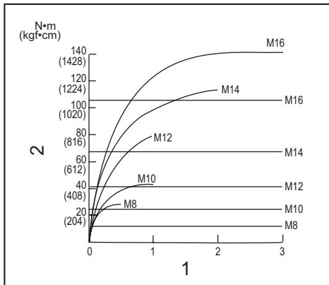
1. Czas dokręcania (s) 2. Moment dokręcania
