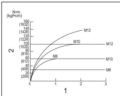
1. Czas dokręcania (s) 2. Moment dokręcania
