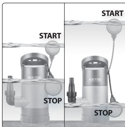
Obr.4, ilustrace funkce plovákového spínače
