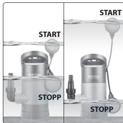
Abb. 4, Darstellung der Schwimmerschalterfunktion
