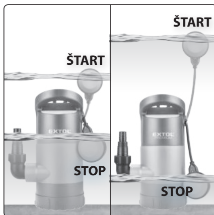
Obr. 4, ilustrácia funkcie plavákového spínača
