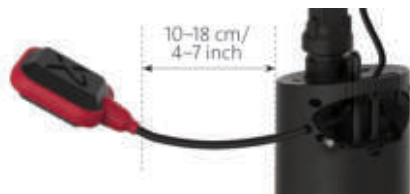
Minimální délka volného kabelu plovákového snímače
