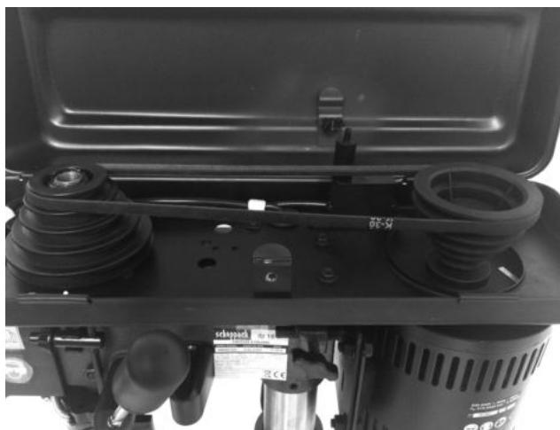
Hvis du ønsker å stille inn hastigheten må du åpne dekslet. For å unngå skadefare vil boremaskinen automatisk bli slått av med sikkerhetsbryteren.
