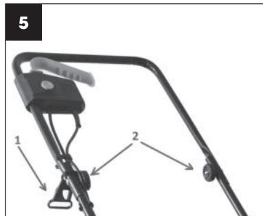
5. Po inštalácii držadla zaistite kábel k držadlu pomocou plastových úchytov (obr. 6).
