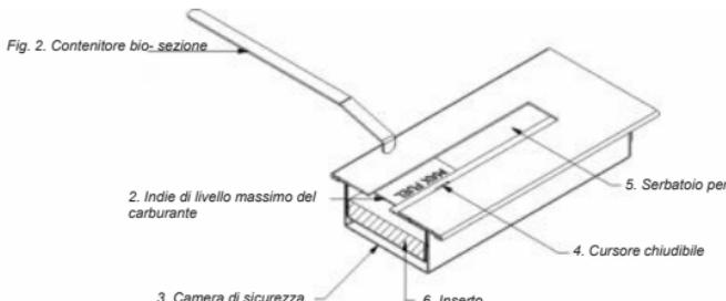
Fig. 2. Contenitore bio- sezione
