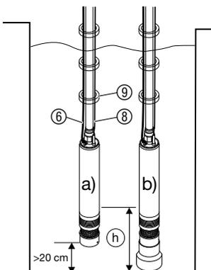
Aby mohlo čerpadlo čerpat, musí být při uvedení do provozu ponořeno do vody až po minimální stav vody ⑩ (viz 9. Technická data).
