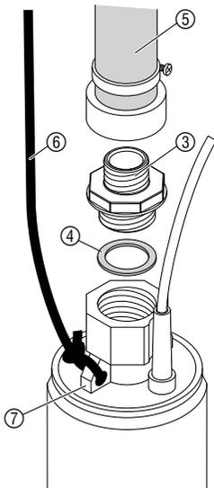
Vnitřní závit 40 mm (1 1/4") na výstupu čerpadla může být v případě potřeby osazen přípojkou ③ s vnějším závitem 33 mm (1") dodanou s čerpadlem. Tím je umožněno připojení čerpadla ke **spojovacímu systému vodních hadic GARDENA** nebo použití **přípojky GARDENA typ 1723 / 1724**.
