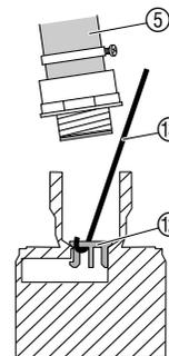
Zablokovaný zpětný ventil ⑫ lze uvolnit pomocí háku z ohnutého drátu ⑬. Zpětný ventil ⑫ se musí volně pohybovat, aby čerpadlo mohlo čerpat.
