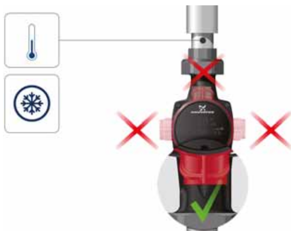
Rys. 4 Pozycja skrzynki sterowniczej w instalacjach klimatyzacyjnych i zimnej wody
