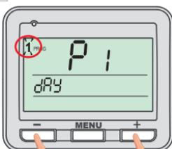
Na pravej strane bliká 1 (- Pondelok). Pomocou tlačidiel **+** / **-** voľte deň (dni) na programovanie. Po výbere stlačte 1x tlačidlo **MENU**.
