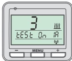
Na prijímači sa niekoľkokrát súčasne rozsvietia obidve diódy a dôjde k niekoľkonásobnému zapnutiu a vypnutiu výstupného relé. Na displeji vysielачa sa striedavo objaví „test On/ test Off“.
