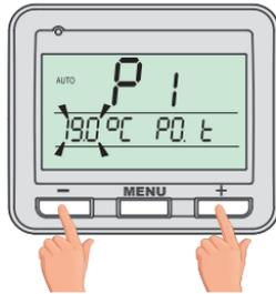
Údaj o požadovanej teplote začne blikať. Tlačidlami **+** alebo **-** možno požadovanú teplotu zmeniť.
