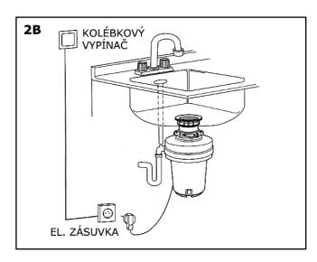
Alternativní variantou je použití nožního spínače nebo využití kompletu dálkového bezdrátového spínače s vlastní baterií a přijímače, kde odpadá nutnost dodatečného přivádění el. instalace a lze jej umístit prakticky kdekoliv, aniž by došlo k porušení bezpečnostních předpisů. Spínač se jednoduše přišroubuje nebo přilepí na určené místo.
