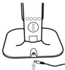
Zapojte přívodní konektor napájecího zdroje do vstupního portu stolní lampičky. Poté zapojte napájecí adaptér do zásuvky elektrické energie.
