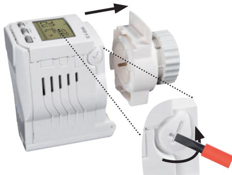
4.3 Uchopte převodovou část hlavice HD13, vyšroubujte ozubené kolečko proti směru hodinových ručiček až na doraz.
