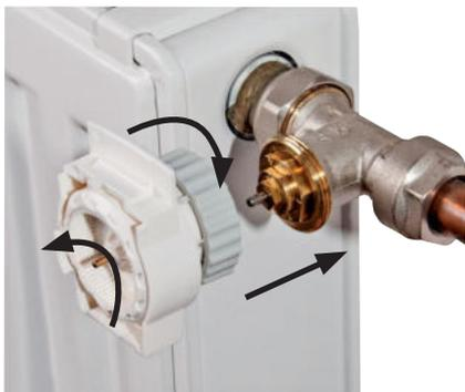
4.4 Uchopte těleso hlavice displejem směrem nahoru, zkontrolujte zda páčka západky směřuje také vzhůru. Potom těleso naklapněte z vrchu dolů na ventil s převodovou částí.
