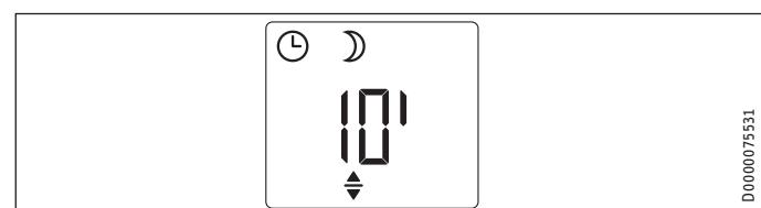
Ve standardním zobrazení vidíte nastavenou dobu v minutách a symbol „Parametry lze editovat“. Pomocí tlačítka „+“ a „-“ lze nastavit libovolný čas 10–120 minut.
