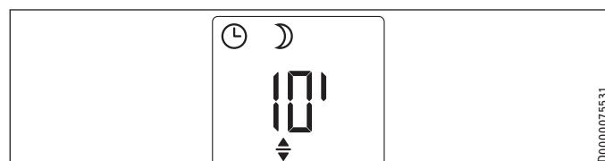
We wskazaniu standardowym wyświetlony zostanie zaprogramowany czas w minutach oraz symbol „Parametr do edycji”. Za pomocą przycisków „+” i „-“ można nastawić dowolny czas od 10 do 120 minut.
