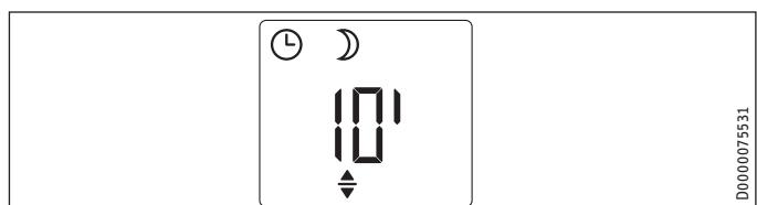
A kijelző alapállapotában a beállított idő (percben) valamint a „Szerkeszthető paraméter” szimbólum látható. A „+“ és a „-“ gombokkal tetszőleges időtartam állítható be a 10...120 perc tartományban.
