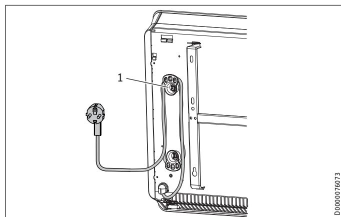
1 Držák pro sítový přívodní kabel
