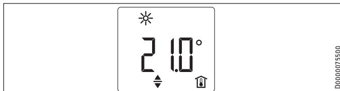
Die Standardanzeige wird dauerhaft angezeigt. Wenn Sie sich innerhalb des Menüs befinden und länger als 20 Sekunden keine Bedieneraktion ausführen, wechselt das Gerät automatisch zur Standardanzeige.
