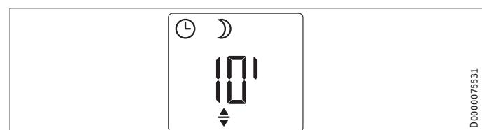
V štandardnej indikácii vidíte nastavený čas v minútach a tiež symbol „Upraviteľné parametre“. Pomocou tlačidiel „+“ a „-“ môžete nastaviť ľubovoľný čas od 10 do 120 minút.
