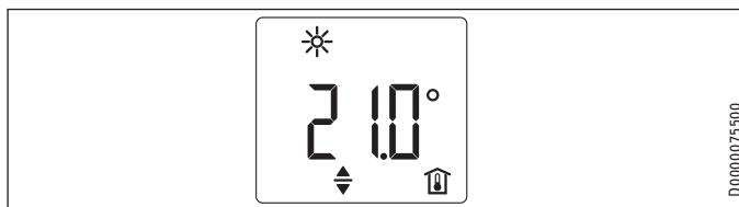
Štandardná indikácia sa zobrazuje trvalo. Ked' sa nachádzate v menu a dlhšie ako 20 sekúnd neobsluhujete prístroj, ten sa automaticky prepne do štandardnej indikácie.
