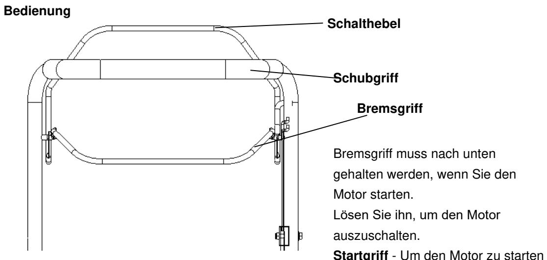
**Schalthebel** - Um die angetriebene Vorwärtsbewegung des Gerätes einzuschalten.
