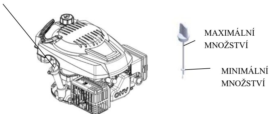
Vaše sekačka je dodávána bez oleje v motoru. Podrobnosti týkající se typu a druhu oleje naleznete v tomto návodu k obsluze v části MOTOR v kapitole Údržba. **Pro verzi RPM 5339 B najdete informace v samostatném návodu k motoru BS.**
