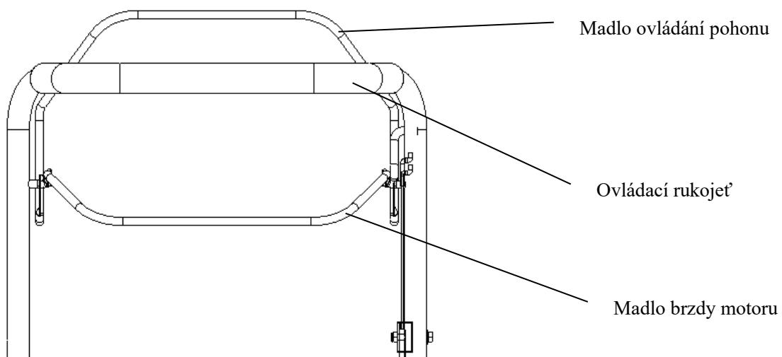
**Madlo brzdy motoru** - musí být přitisknuto k rukojeti, aby bylo umožněno nastartování motoru.
