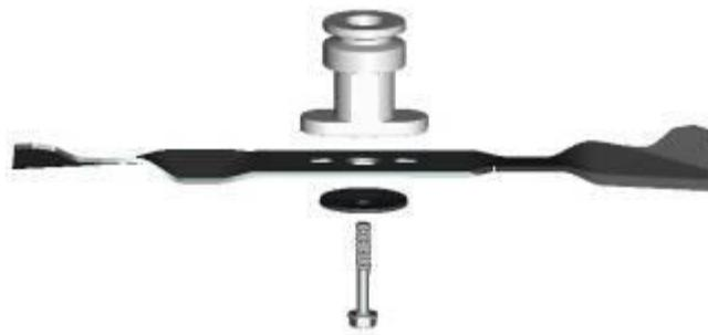
**Setzen Sie wieder alles so ein wie abgebildet. Befestigen Sie die Schraube ordnungsgemäß. Befestigungsdrehkraft beträgt 45Nm. Ersetzen Sie auch die Schraube der Klinge, wenn Sie die Klinge ersetzen.**
