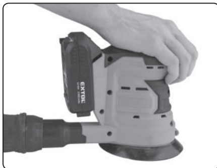
Obr. 5, vedenie brúske po brúsenom povrchu rukou
