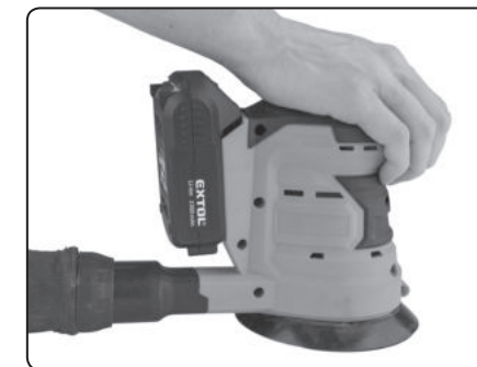
5. ábra. A csiszoló vezetése a felületen
