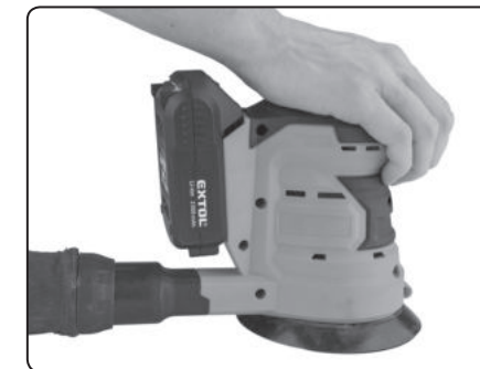
Obr. 5, vedení brusky po broušeném povrchu rukou
