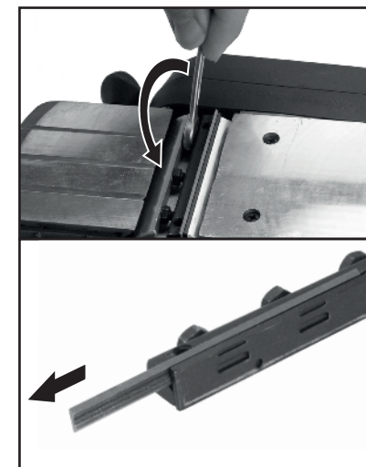
8. ábra. A késtartó kiserelése és a kés kivétele
