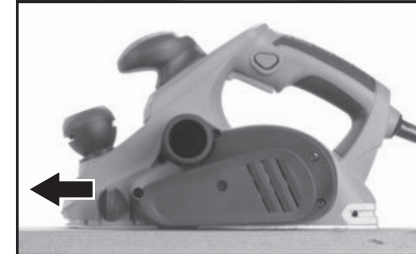
Obr. 5B, sklopení trnu při hoblování od kraje
