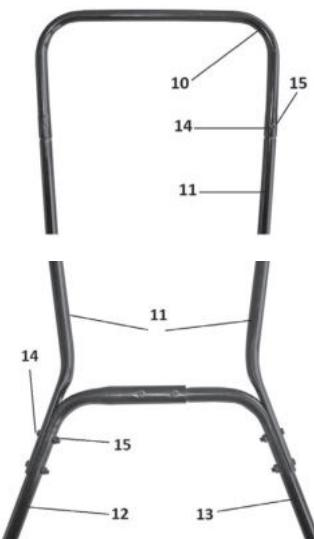
Přiloženými šrouby M6x30 (14) a matkami M6 (15) spojte spodní díl madla A se spodním dílem madla B, a dále je spojte ke středním dílům madla (11).
