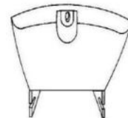
STÜTZE DER GERADEN SEITE: Wird an der geraden Seite der Pools verwendet - beachten Sie die quadratische Vertiefung. Wird an ovalen Stützen verwendet.
