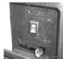
4. Pomaly ťahajte samonavijacím štartérom tak dlho, dokiaľ nedôjde k záberu, potom zaň prudko zatiahnite. Ihneď po štarte motora štartér pusťte.
