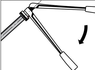
Megjegyzés: a jobb eredmény elérése, illetve a fogó erősebb zárása érdekében a csővéget célszerű lánggal kissé megmelegíteni.
