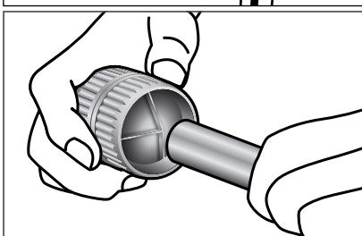
3. Nasuneme trubku na expanzní nástavec a rukojetí rozevřených kleští sevřeme nadoraz (obr.3)
