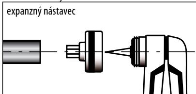
2. Rukoväti pákových klieštie rozvorieme na maximum a na závit hlavy klieštie naskrutkujeme expanzny nadstavec (obr. 2). Na expanzny nástavec nasunieme rúrku. Koniec rúrky je výhodné najprv ošetriť odhortovačom.
