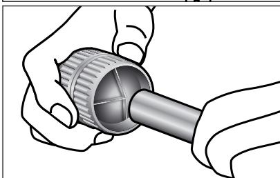
3. Toljuk rá a csövet a csőtágító toldatra, a fogó szétnyitott nyelét pedig ütközésg nyomjuk össze (3. ábra).
