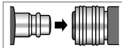
Szétcsatlakoztatáshoz nyomja le a gyorscsatlakozó aljzatának a gyűrűjét, és a dugót tolja ki.
