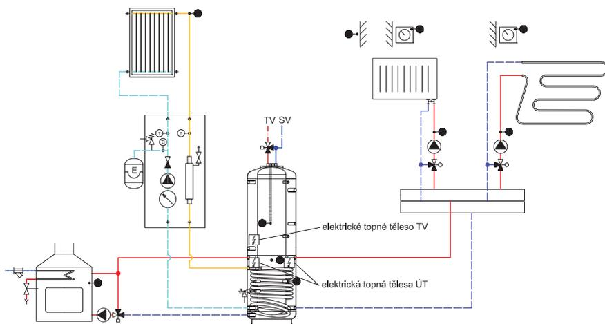
**Schéma 2: Solární sestava na přitápění v kombinaci se spínaným kotlem (na plyn, elektro, na LTO, ...) a krbem**
