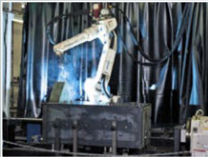
Robotizované svařovací CNC pracoviště
