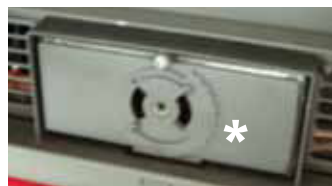
Valvola regolazione aria di combustione, manovrabile ad antenna chiusa tramite mano fredda
