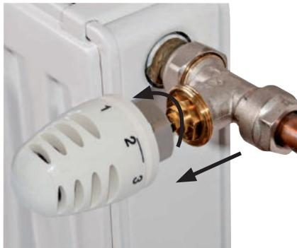
4.3 Uchopte prevodovú časť hlavice HD13-L, vyskrutkujte ozubené koliesko proti smeru hodinových ručičiek až na doraz. Nasad'te prevodovú časť s maticou na ventil a rukou dotáhnite maticu na ventil (NEPOUŽIVAJTE ŽIADNE NASTROJE!).
