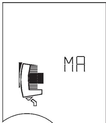
Le réglage ↘ sur MA fait s'afficher SL sur cet écran. Lorsque l'esclave (SL) a été activé par le réglage ↓, l'autre pompe (de droite) devient maître. Une permutation entre le maître et l'esclave a donc eu lieu.
