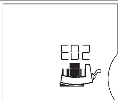
Bij een storing wordt de actuele storing door E = Error, het **codenr.** en door het knipperen van de storingsbron motor, regelmodule of netaansluiting weergegeven.
