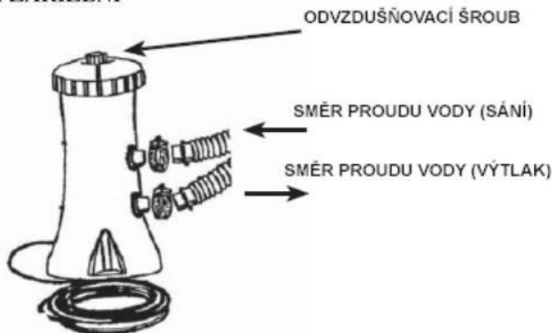
Filtraci zarizeni prvne odvzdusnete! Odvzdusneni se provadi po usazeni filtrace na sve pevne misto pod urovni hladiny vody v bazenu pred pripojenim do zasuvky. Pred odvzdusnenim je vhodne doplnit vodu do bazenu tak, aby byl plny. Pri odvzdusneni napojte filtraci na bazen a povolte odvzdusnovaci zavít. Az bude vytiekat voda, odvzdusnovaci zavít utahnete.
