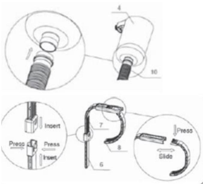
Povolte sroub skimmeru, zasunte zavesny hak a opet utahnete. Umistete na bazen. Nepouzivejte kleste nebo podobne nastroje. Umistete cely sestaveny hak na horni stranu nafukovaciho prstence bazenu a blizko privodu vody. Nastavte hak tak, aby dobre prilehal k nafouknutem prstenci. Ujistete se, ze je hak bezpecne pripevnen k bazenu.
