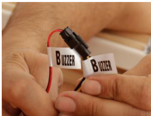
Foto č. 19 – ukázka připojení kabelů bzučáku
