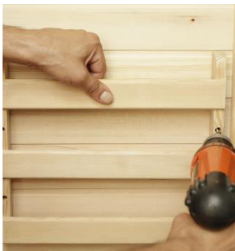
Foto č. 22 – přišroubování držáku na noviny
