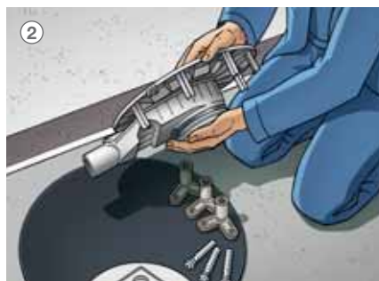
2 Přizpůsobte výškově nastavitelné dno odtoku Advantix Top podmínkám stavby.
