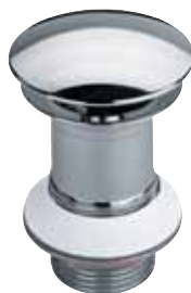
Vřetenový ventil Visign V1 z pochromované mosazi, s funkcí přepadu. Uzavíratelný kulatou Klick-krytkou
