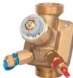
Ventil AB-QM umožňuje automatické vyvažování průtoku v soustavách vytápění a chlazení. Jedná se o automatický regulátor průtoku kombinovaný s regulačním ventilem. K měření a regulaci průtoku již není zapotřebí žádné další zařízení.
