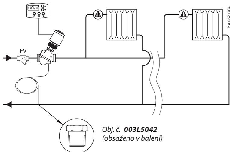
AB-PM je kombinovaný automatický vyvažovací ventil. Nabízí tři funkce v kompaktním tělese ventilu: 1. Regulátor diferenčního tlaku 2. Regulační ventil s lineární charakteristikou 3. Omezovač průtoku
