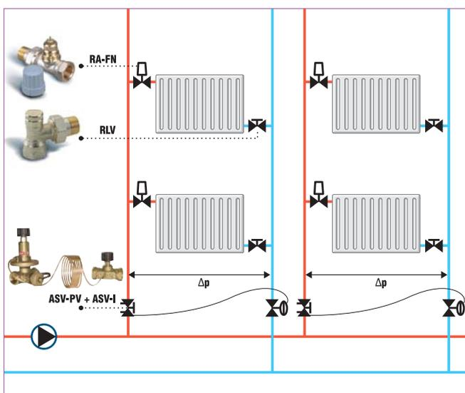
Termostatický ventil reguluje průtok každým radiátorem, ale nemá vestavěné přednastavení.
