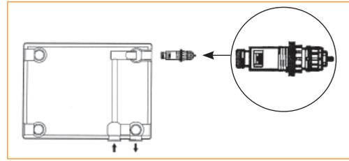
Používají se k vybavení radiátorů určených pro integrované ventillové těleso. Jsou vhodné pro hlavice z řady RA 2000: RA 2980 – RA 2920 a RAE. Integrované ventily jsou vybaveny přednastavením. Zařízení může být doplněno šroubením RLV-K (viz str. 32).
