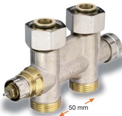
VHS je připojovací armatura pro topná tělesa se spodním připojením s roztečí přípojek 50 mm a integrovaným, přednastavitelným ventilem. Nenápadná montáž hlavice pod radiátorem.
