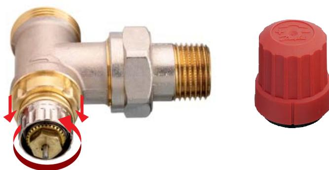
Přednastavitelné termostatické ventily RA-N mají největší rozsah přednastavení průtoku a možnost nejcitlivějšího nastavení v rámci tohoto rozsahu na trhu. Ventilovou vložku lze vyměnit pomocí speciálního demontážního přístroje bez nutnosti vypouštění soustavy. Ventilová ucpávka je při dodání chráněna plastovou čepičkou, aby nedošlo k jejímu poškození a je možno ji kdykoliv vyměnit.
