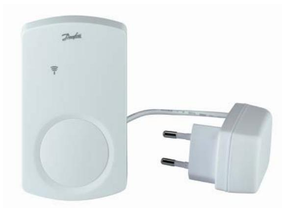
Danfoss Link™ CF-RU - Zesilovač, který prodlužuje dosah obousměrné bezdrátové komunikace mezi Danfoss Link™ CC, bezdrátovými termostatickými hlavicemi *living connect*, bezdrátovým snímačem teploty RS a dalšími připojenými komponentami. Zesilovač je zvláště užitečný v případech, kdy mohou být bezdrátové komunikace negativně ovlivněny stavebními prvky a kovovými předměty. Napájení CF-RU je 230V.
