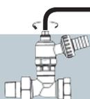
Pomocí šroubení RLV lze otopná tělesa i vypustit. Pro snadné vypouštění vody z tělesa je nutno namontovat šroubení krytkou dopředu. Při vypouštění vody stačí odmontovat kryt, uzavřít pomocí imbusového klíče vel. 6 a namontovat vypouštěcí ventil. Vypouštění se posléze provede otočením imbusového klíče.
