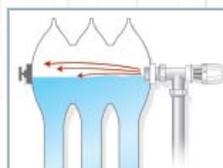
Mírně nakloňte radiátor a pokračujte odvzdušněním zařízení.
