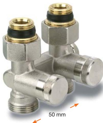
Šroubení RLV-K je přepínatelné z dvoutrubkového na jednotrubkový provoz. Šroubení typu RLV-K je poniklované a dodává se v rohovém a přímém provedení. Pomocí šroubení se může každé topné těleso s roztečí připojovacích hrdel 50 mm individuálně bez problému a bez ovlivnění ostatního zařízení uzavřít a těleso vypustit.
