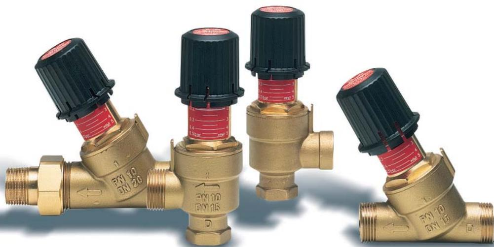
Zajišťují minimální průtok k řízení diferenčního tlaku v soustavě ústředního vytápění a zajišťují tak správnou funkci kotle, pokud jsou termostatické ventily uzavřeny. Rozsah nastavení od 0,05 do 0,5 bar.
