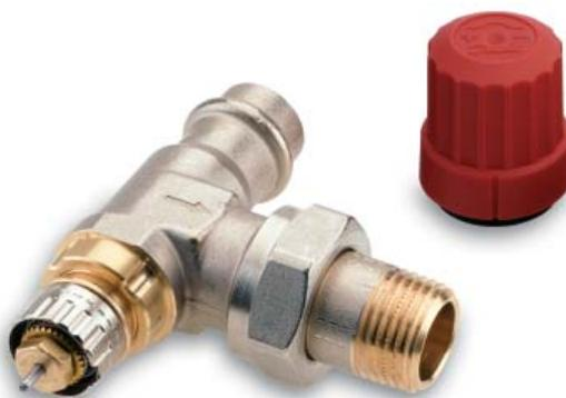
Armatury RA-N s Press fit připojením pro dvoutrubkové soustavy s nuceným oběhem. Připojení na soustavu lisovaným spojem. Údržba a nastavení je stejné jako u klasických termostatických radiátorových ventilů RA-N.
