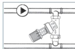
Snižte rychlost čerpadla, je-li to možné. Nainstalujte přepouštěcí ventil typu AVDO, které omezuje diferenční tlak, jakmile se termostatické ventily uzavřou.
