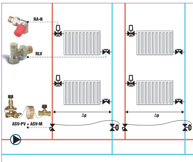
Průtok lze v každém radiátoru regulovat pomocí termostatického ventilu s přednastavením RA-N.
