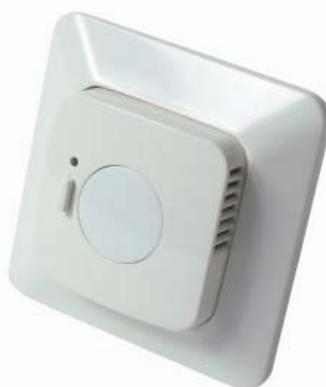
Danfoss Link™ FT je spínací relé, vybavené snímačem teploty ve funkci omezovače. Bezdrátově obousměrně komunikuje s řídicí jednotkou Danfoss Link™ CC. Napájena je 230V. Předává centrální jednotce údaje o skutečné teplotě měřené kabelovým snímačem, instalovaným obvykle v podlaze.
