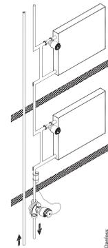
Einsatz zur Zonenregelung. Thermischer Stellantrieb TWA in Kombination mit Raumthermostat/Steuergerät.
