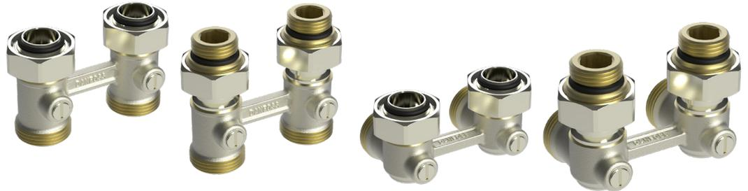
Mit dem Hahnblock-Ventil vom Typ RLV-KB lässt sich jeder Ventilheizkörper mit einem Mittenabstand von 50 mm zwischen den Anschlüssen einzeln blockieren. So sind beispielsweise störungsfreie Wartungsarbeiten ohne Beeinträchtigung der anderen Teile der Anlage möglich.
