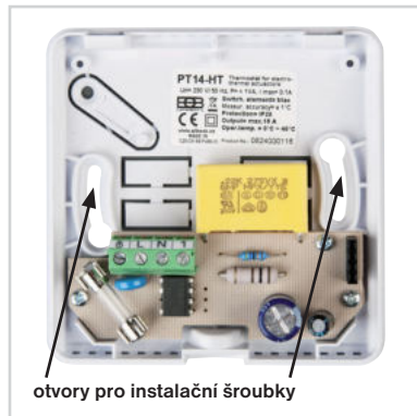
Obr.4 Nasadíte díl s elektronikou na spodní část a zajistíte pojistným šroubem.
