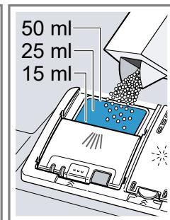
Pokud používáte tablety, stačí jedna tableta. Tablety vkládejte napříč. Pokud používáte práškový nebo tektutý mycí prostředek, dodržujte pokyny k dávkování výrobce a návod k dávkování zásobníku mycího prostředku.
