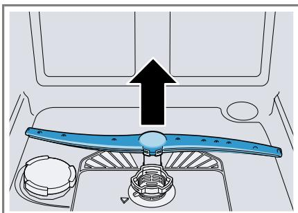
3. Pod tekoucí vodou zkонтrolujte, zda nejsou ucpané výstupní trysky ostříkovacích ramen a popř. odstraňte cizí tělesa.
