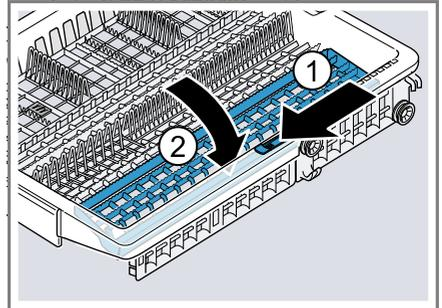
2. Um die Klappstacheln umzuklappen, den Hebel nach vorn drücken und die Klappstacheln umklappen ①.
