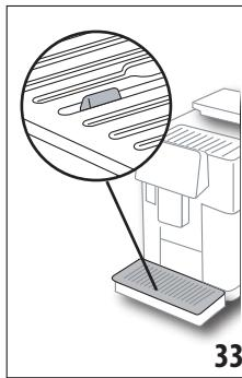
3. Den Tassenrost (A21) und den Rost der Abtropfschale (A22) entnehmen, dann die Abtropfschale und den Kaffeesatzbehälter leeren und alle Teile waschen;
