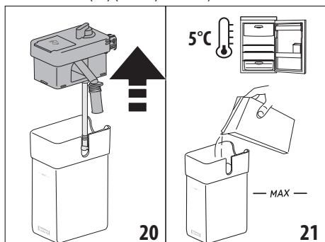
2. Eine ausreichende Menge Milch in den Milchbehälter (D10) füllen, wobei der auf dem Behälter angegebene Füllstand MAX nicht überschritten werden darf (Abb. 21). Dabei ist zu beachten, dass jeder Strich auf dem Behälter ca. 100 ml Milch entspricht;
