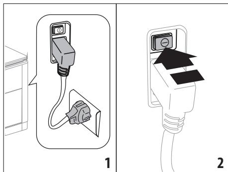
1. Den Steckverbinder des Netzkabels (C6) in seine Aufnahme (A8) an der Rückseite des Gerätes stecken, das Gerät an das Stromnetz anschließen (Abb. 1) und sicherstellen, dass der Hauptschalter (A7) an der Rückseite des Gerätes gedrückt ist (Abb. 2);
