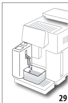
3. Drehen Sie den Milchschaumregler (D3) auf „Clean“ (Abb. 28): aus dem Milchauslauf fließen Heißwasser und Dampf (Abb. 29). Die Reinigung wird automatisch abgebrochen;
