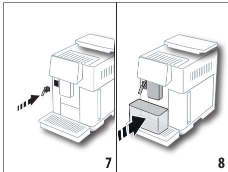
6. Den Entkalkungsauslauf (C7) (im Starter-Set enthalten) in den Verbinder des Milchbehälters (A13) einsetzen (Abb. 7) und einen Behälter mit einem Mindestfassungsvermögen von 100 ml unter den Kaffeeauslauf (A14) und den Entkalkungsauslauf stellen (Abb. 8);
