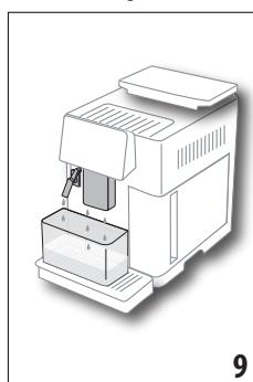
7. „Ok“ drücken, um den Wasserkreislauf zu füllen: das Gerät gibt Wasser aus den Ausläufen aus (Abb. 9);
