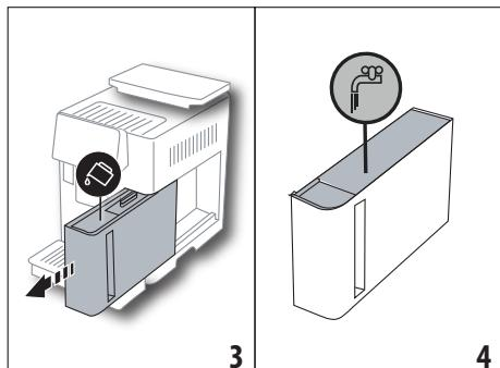
3. den Wassertank (A20) (Abb. 3) entnehmen, bis zur Markierungslinie MAX (auf der Innenseite des Tanks aufgedruckt) mit frischem Wasser füllen (Abb. 4);
