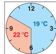
Die Solltemperatur wird automatisch vom Thermostat für die Zeit von 8 Stunden nach dem Drücken der Taste um 3 °C reduziert!
