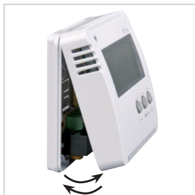
Abb.4 Den Bedienungsteil setzen Sie bitte auf den unteren Deckel ein und ziehen Sie die Stellschraube an.
