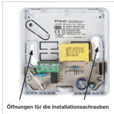
Abb.4 Den Bedienungsteil setzen Sie bitte auf den unteren Deckel ein und ziehen Sie die Stellschraube an.
