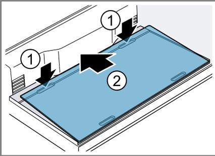
2. In die beiden Vertiefung vorn am Kühlfachboden greifen ①, die Kühlfach-Glasplatte anheben und entnehmen ②.
