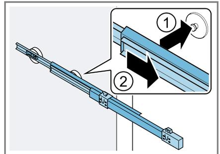
2. Die Auszugsschiene am hinteren Bolzen einsetzen ① und die Verriegelung nach hinten schieben ②.
