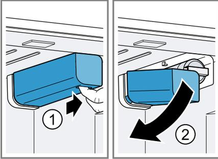
2. Den Wasserfilter nach links unten klappen ①, um 90° gegen den Uhrzeigersinn drehen ② und entnehmen ③.
