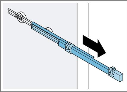
2. Die Verriegelung in Pfeilrichtung schieben ① und vom hinteren Bolzen lösen ②.
