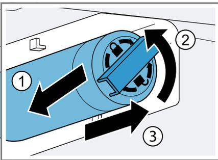
**Hinweis:** Beim Entnehmen tropft etwas Wasser aus dem Wasserfilter. Das Tropfwasser mit einem trockenen Tuch entfernen.
