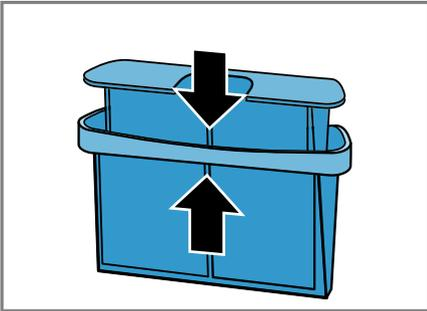
8. Das zweiteilige Flusensieb einsetzen.
