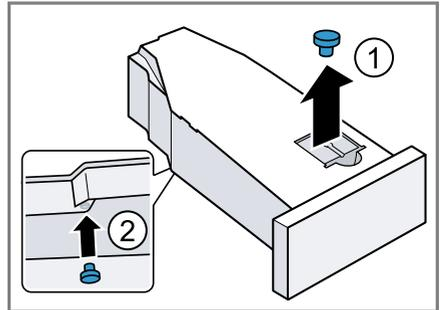
2. Den Filter im Kondenswasserbehälter reinigen.
