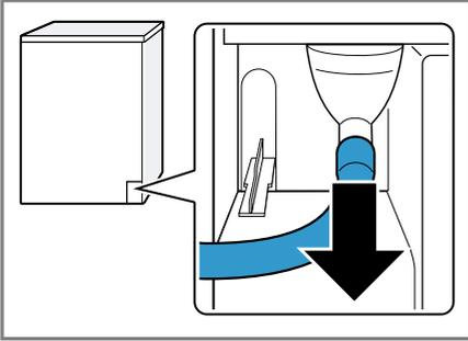
Der Kondenswasserschlauch ist werkseitig am Stutzen angeschlossen.
