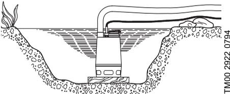
Abb. 2 Aufstellen der Pumpe auf einer Platte
