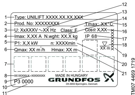
Abb. 6 Beispielhaftes Typenschild
