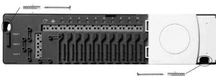
1. Irrota etu- ja sivupaneelit ja kiinnitä ruuveilla ja propuilla.
