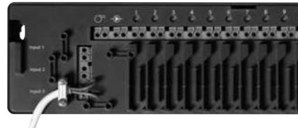
1. Einen externen EIN/AUS-Schalter an den Klemmen für Heizung und Kühlung anschließen. Wenn dieser Schalter geschlossen (EIN) ist, schaltet das System von Heizung auf Kühlung um.
