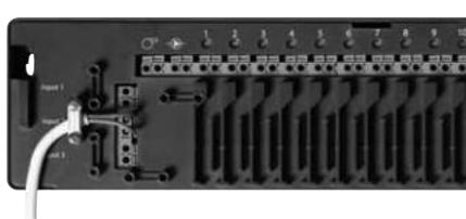
1. Anslut en extern PÅ/AV-brytare till konstantfunktionens plintar. När brytaren är stängd (PÅ) kommer systemet att åsidosätta börvärdena för alla rumstermostater och i stället ställa in värdet 15 °C.
