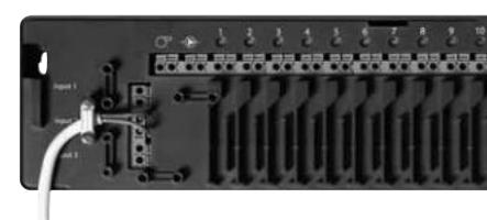
1. Podłączyć wyłącznik zewnętrzny do zacisków funkcji zdalnej. Kiedy wyłącznik ten jest zamknięty (WŁ.), system skasuje bieżącą wartość zadaną dla wszystkich termostatów i zamieni ją na 15°C.
