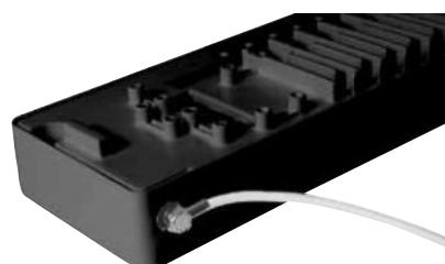
2. Tilslut den eksterne antenné, og anbring den på den anden side af transmissionsbarrieren.
