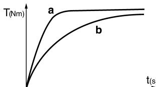
Au bout d'env. 5 secondes de frappe, on a obtenu le couple de serrage maximal.
