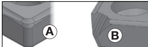
Fig. A: normalt slitage: Vrid vändskärplatta/byt ut.
